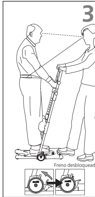
3. Desbloquee el freno con un pie. Tire del Molift Raiser Pro hacia atrás y llévalo al nuevo asiento. Asegúrese de que las ruedas de este estén bloqueadas. El traslado será mejor si el paciente se coloca en la dirección del movimiento
