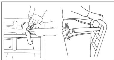
No abroche el cierre del cinturón ReTurnBelt antes del levantamiento. Una vez situado el usuario en pie y de cara a ReTurn, el cinto puede colocarse alrededor de una de las asas verticales.
