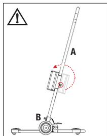
A. Handtagsstegen/röret trycks ned i fästet på chassiet så att höjjusteringsknapparna är monterade mot medhjälparens sida.
