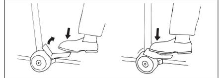
Ogni ruota è dotata di un freno. Con il piede, premere la leva del freno indicata da un simbolo rosso. Premerla fino in fondo.
