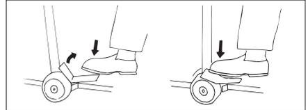
Jedes Rad ist mit Bremse versehen. Treten Sie auf die rote Kennzeichnung der Fußbedienungsfläche und achten Sie darauf, dass sie bis zum Anschlag getreten werden muss.
