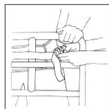
Accione el freno de ruedas de ReTurn. Compruebe que el usuario se halle en pie en una posición segura de cara a ReTurn para poder soltar el cinto de bloqueo.
