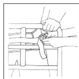
Brems hjulene på ReTurn. Læn brugeren fremad, så låsebåndet bliver slapt. Lås spændet op og træk båndet væk fra ReTurn, fold det gerne ind under kanten på bæltet, så det ikke hænger fast nogen steder. Hjælp brugeren med at komme ned i siddende position ved at assistere ved hjælp af ReTurnBelt.
