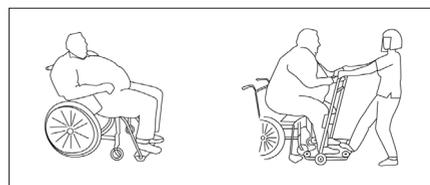
Mikäli potilas liikkuu eteenpäin istuessaan pyörätuolissa, ReTurn siirtolaite voidaan käyttää potilaan siirtämiseen taaksepäin pyörätuoliin istuimessa.
