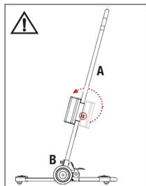
A. Spingere la struttura nei punti di fissaggio del telaio, in modo che i pulsanti per la regolazione in altezza siano rivolti verso l'operatore.
