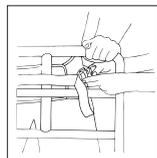
Freiner les roues de ReTurn. Pencher l'utilisateur vers l'avant de sorte que la sangle de blocage se détende. Ouvrir la boucle et retirer la sangle de ReTurn, la replier sous le bord de la ceinture, de sorte qu'elle ne se bloque nulle part. Descendre en position assise en l'aidant avec ReTurnBelt.
