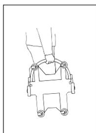
El chasis y la escalera de ascenso pueden transportarse por separado. Lleve el chasis sujetando el tubo del extremo delantero del producto.
