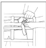
Bloccare le ruote di ReTurn. Accertarsi che il utente sia sicuro in posizione eretta di fronte a ReTurn per poter sganciare l'imbracatura. Sganciare e rimuovere l'imbracatura da ReTurn.
