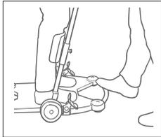
Die Unterschenkelstütze ist so einzustellen, dass die Oberkante der Stützschiene etwa 3 cm/2 Finger breit unter der Unterkante der Kniekehle/Gelenkspalte zu liegen kommt. Zum Lösen die beiden Sperrknöpfe herausziehen und richtige Höhe einstellen.
