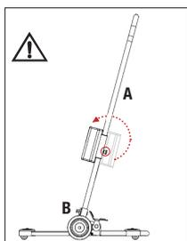
A. Håndtaksstigen/røret trykkes ned i festet på chassiset slik at høydejusteringsknappene er montert mot medhjelperens side.
