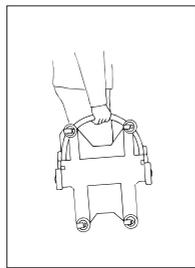
Untergestell und Rahmen können einzeln getragen werden. Das Untergestell beim Tragen am vorderen Rohrbogen fassen. Um den Transport im Auto sowie die Aufbewahrung zu erleichtern, lässt sich ReTurn in zwei Teile zerlegen.
