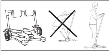
Das Untergestell entsprechend der Kennzeichnung auf der Bodenplatte betreten. Das Gewicht des Benutzers muss innerhalb der Stützfläche des Produktes liegen (das gesamte Gewicht innerhalb der Räder), das heißt, er muss aufrecht stehen. Der Körperschwerpunkt des Benutzers darf nicht außerhalb der Stützfläche liegen.
