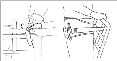
Die Sicherungsschnalle vor dem Aufstehen nicht am ReTurnBelt befestigen. Befindet sich der Pflegebedürftige in stehender Position am ReTurn lässt sich der Sicherheitsgurt an einem der vertikalen Griffe an der Aufrichtleiter anbringen.
