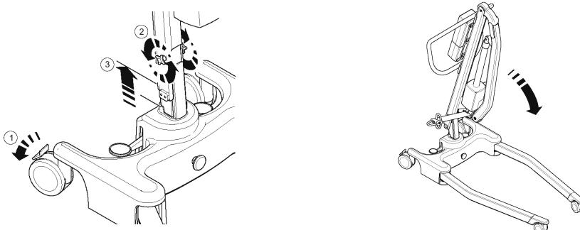
**4.** Til de opgevouwen Advance rechtop (met behulp van het onderstel en de duwbeugel als richtlijn); zorg ervoor dat de mast en tilarm samen blijven wanneer u het apparaat rechtop zet.
