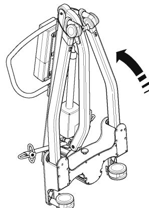
**5.** Tirare la cinghia per il blocco della base saldamente verso l'alto ed agganciarla intorno alle ruote. In questo modo la base, l'albero e il braccio rimarranno attaccati per il trasporto e qualora il sollevatore non venga utilizzato.
