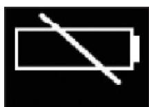
Le symbole de la batterie vide indique que la batterie est complètement déchargée et doit être mise en charge immédiatement.
