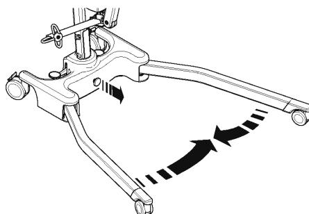
3. Desserrez suffisamment le dispositif de blocage du mât afin de pouvoir lever le mât. Levez le mât entièrement jusqu'à ce qu'il atteigne la butée d'arrêt. Pliez délicatement le mât en direction des pieds. Aidez-vous de la poignée pour faciliter cette action.
