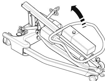
4. Sollevare l'albero in posizione verticale utilizzando la parte superiore della maniglia di spinta ed inserirlo nell'incavo (1). Stringere la manopola di blocco (2) e sbloccare le ruotine provviste di freni (3).
