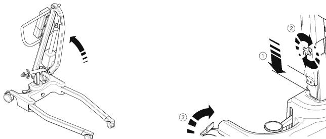
5. Aprire completamente la base. ASSICURARSI che la manopola per il blocco sia allineata alla base per impedire il movimento di quest'ultima. La base funzionerà solo se si utilizza il meccanismo a pedale situato sul retro.
