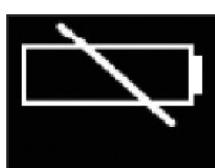
Quando il visore visualizza il simbolo di batteria scarica significa che l'autonomia della batteria è esaurita e che deve essere immediatamente ricaricata.
