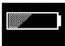
Le symbole de la batterie à moitié pleine indique qu'il est nécessaire de recharger la batterie.
