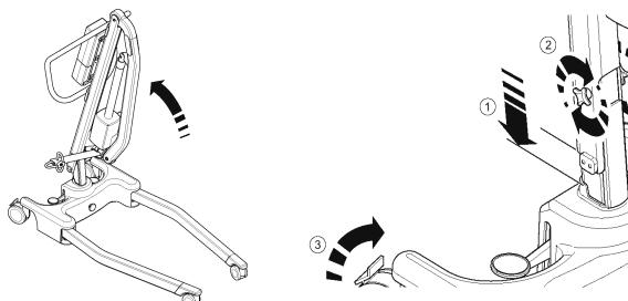
5. Écartez les pieds au maximum. ASSUREZ-VOUS que le bouton de verrouillage des pieds arrive à ras de la base et que les pieds ne puissent plus bouger. Les pieds ne fonctionneront alors qu'au moyen du mécanisme à pédale situé à l'arrière de la base.
