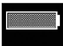
Si aparece el ícono de la batería completa, significa que la batería está completamente cargada y lista para usar.
