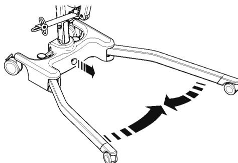
3. Allentare il dispositivo di bloccaggio dell'albero fino a quando è possibile spostarlo verso l'alto. Estrarre completamente l'albero fino a raggiungere il suo punto di arresto. Ripiegare con attenzione l'albero contro le gambe del sollevatore. Aiutarsi con la maniglia di spinta.
