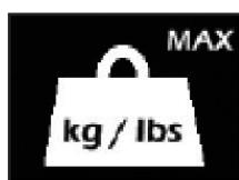
Se il sollevatore si arresta a causa di un sovraccarico (ovvero un tentativo di sollevare un carico superiore a quello di sicurezza) sul visore LCD appare il simbolo del sovraccarico e il sollevatore si arresta fino alla rimozione del carico in eccesso (superiore al limite di sicurezza).
