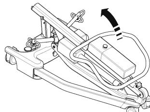
4. En l'attrapant par le haut de la poignée, redressez le mât en position verticale de sorte à l'insérer dans la fente (1). Serrez les molettes de verrouillage du mât (2) et déverrouillez les roulettes (3).
