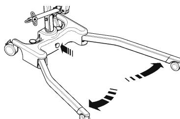
6. Suelte la barra separadora del soporte de sujeción. El elevador ya está listo para funcionar.
